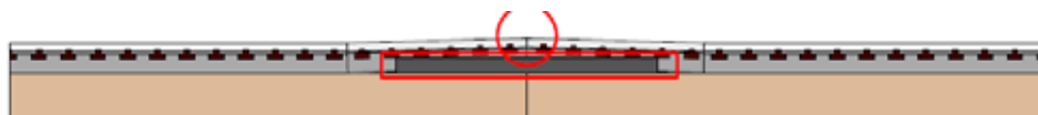
図-21 バリアブルレールの厚みで接続部が凸形になっている
