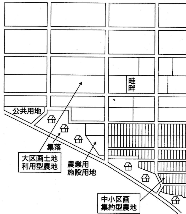
図1 大区画水田と中小区画水田の配置図 (農業土木学会：土地改良事業計画設計基準計画ほ場整備(水田)，2001)
