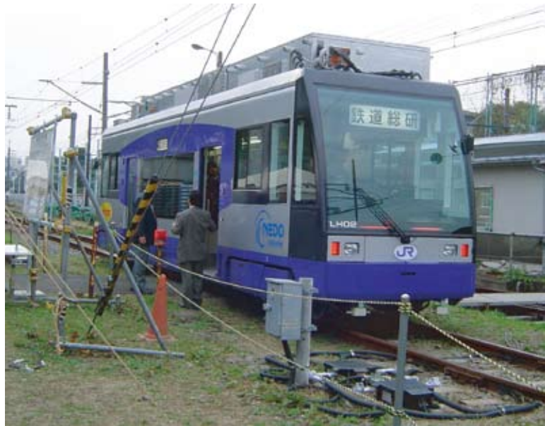
▲鉄道総研で開発中のバッテリートラム「Hi-tram」川崎重工の「SWIMO」と共に平成二十年三月まで札幌市電の営業路線で試験走行が行われる。
