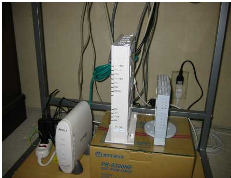
左 = 無線ルーター、中央 = PR-S300NE ルーター、右 = SCM-PDS 光終端装置
